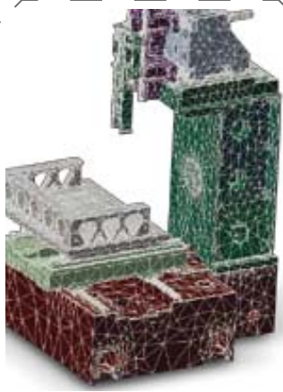
VÉGESELEM RENDSZERREL TERVEZETT GÉPTEST
