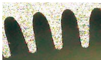
SAROKVEZÉRLÉS 200×CCD KAMERA FELVÉTEL R=0,060 MM RÁDIUSZ
